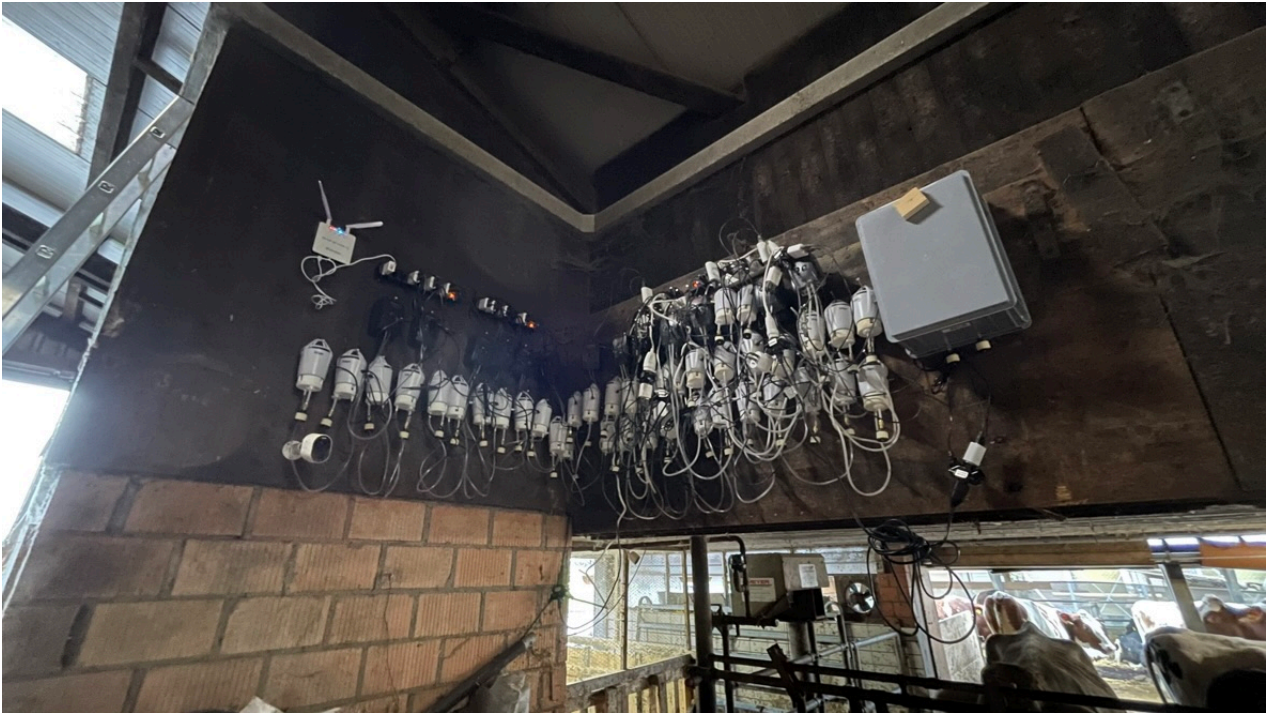
Abbildung 4: Sensoren im Rindviehstall für den Quervergleich nach einer Messkampagne
