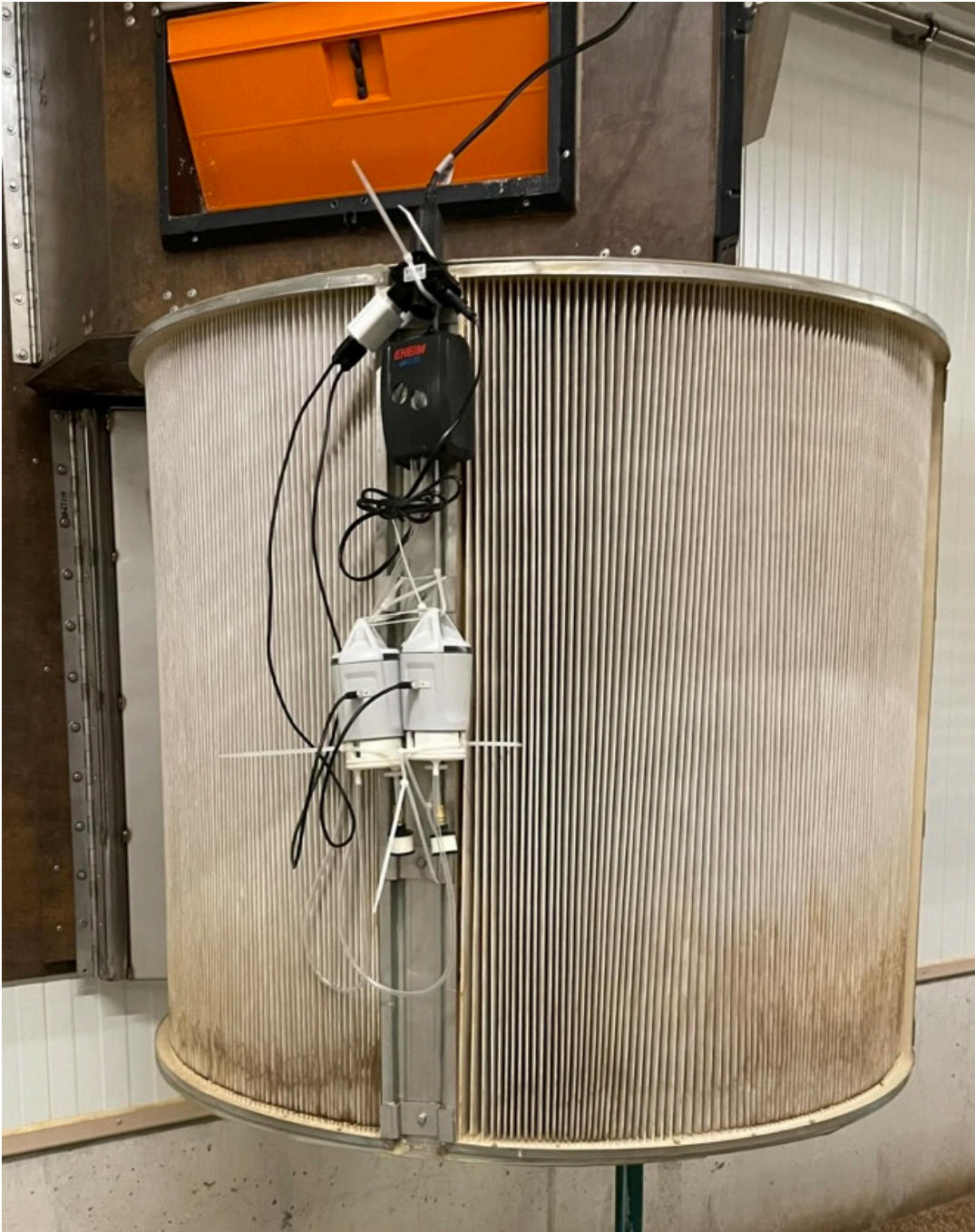
Abbildung 3: Sensoren (Dräger XNode) im Stall 2 vor der Abluft der WRG
